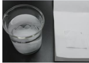
試験手順 1 より：人工汗液の成分 L-ヒスチジン水溶液への漬け込み
